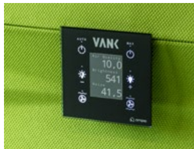
Panel ścienny 6-polowy PA-6 do stopniowej regulacji oświetlenia i wentylacji z czujnikiem czystości powietrza, natężenia oświetlenia i poziomu hałasu. Możliwość sterowania automatycznego lub manualnego.
